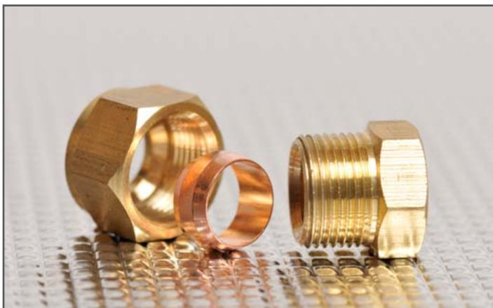
Le raccord rapide, qu'il soit bicône ou américain, facilite la mise en œuvre des tuyaux en cuivre. Contrairement au raccord en cuivre, il ne se soude pas. Il n'a pas non plus besoin de collet battu, mais il doit rester apparent.
