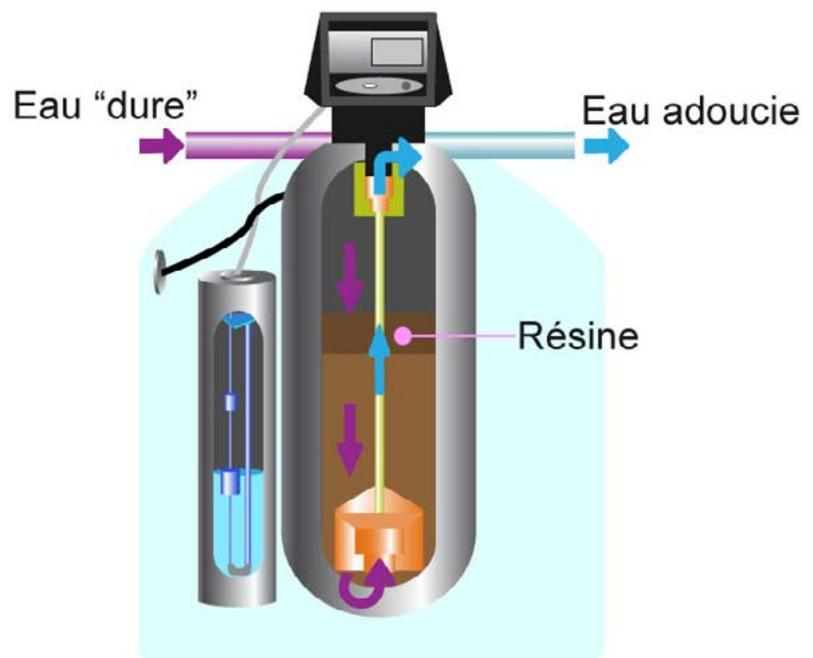
Un adoucisseur comporte deux réservoirs : l'un contient des résines minérales, l'autre des sels régénérants. Le système se régénère à l'aide de ces sels lorsque la résine arrive à saturation. La régénération peut-être programmable selon l'appareil ou bien automatique, à partir du volume d'eau.
