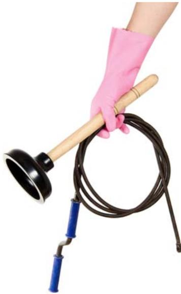
Il suffit donc d'enfoncer le furet dans la canalisation et de tourner la manivelle, qui s'enfonce dans le bouchon et l'élimine. Ensuite, tirez la chasse et vérifiez si l'eau est aspirée correctement.
