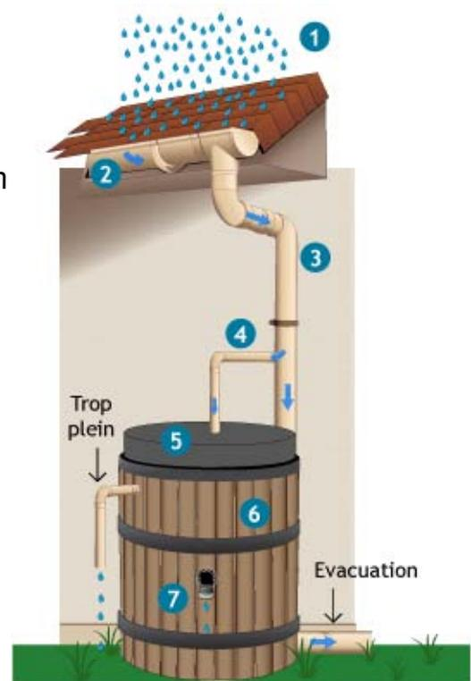
de ses impuretés. L'ajout d'une crapaudine à vos descentes d'eau pluviale et la pose de grillages sur vos gouttières sont un premier filtre contre les débris divers.
