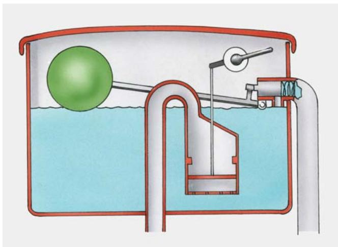
Le réglage fait, ouvrez l'arrivée d'eau, remplissez la cuve et vérifiez si l'eau s'écoule toujours. Si c'est le cas, videz un peu la chasse, réglez à nouveau et vérifiez jusqu'à ce que la fuite ait cessé. Si rien n'y fait, il faut certainement changer le flotteur.
