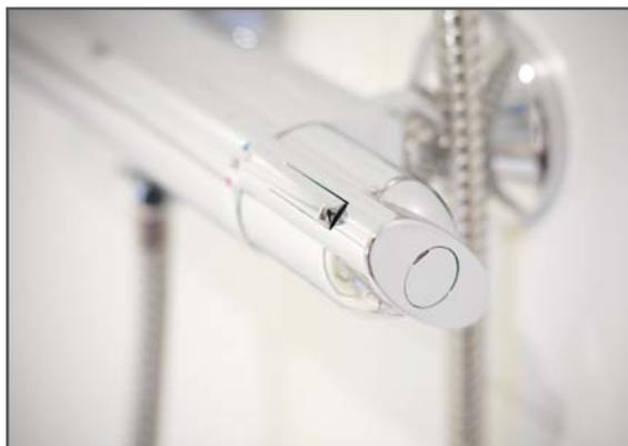
Contrairement aux robinets simples et mélangeurs, le mitigeur thermostatique n'a qu'une seule tête et une poignée centrale. Il s'agit d'une robinetterie haut de gamme. Généralement installé en mural, sa fixation se fait avec deux percements. Le boîtier est intégré dans la cloison et caché par un enjoliveur démontable pour faciliter l'entretien.
