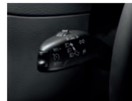
Le régulateur de vitesse. Il maintient la vitesse choisie par le conducteur à partir de 30 km/h, et ce, même en côte ou en descente. Pour désactiver le système, il suffit d'appuyer brièvement sur le bouton de commande ou sur la pédale de frein.
