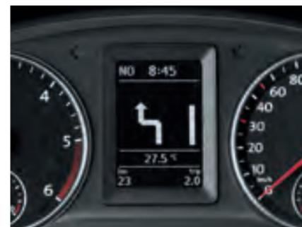
**L'affichage multifonction " Plus ".** L'écran TFT monochrome présente les informations de conduite en temps réel (température extérieure, autonomie, vitesse moyenne, consommation de carburant).
