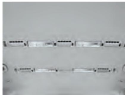
**Le ciel de toit.<sup>2)</sup>** Les diffuseurs d'air dans le ciel de toit assurent l'apport d'air frais dans l'habitacle et diminuent la buée sur les vitres. Les liseuses intégrées sont orientables.
