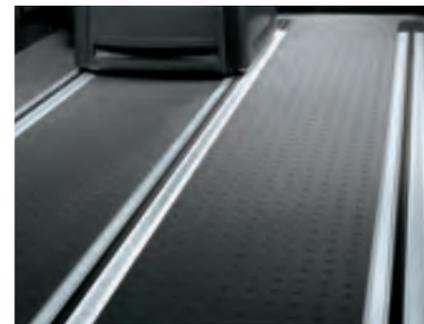
**Le système de glissières.** Pour déplacer facilement et rapidement la banquette trois places, les sièges indépendants et la boîte réfrigérée. Les Multivan Highline et Confortline, avec deux portes coulissantes, sont équipés d'un système à six glissières.
