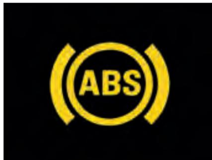
**Le système d'antiblocage des roues (ABS).** Il empêche le blocage total des roues et améliore considérablement la tenue du véhicule en cas de freinage brusque.
