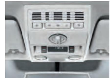
**Le chauffage stationnaire.** Il fonctionne indépendamment du chauffage et de la ventilation et peut être commandé avec ou sans télécommande.
