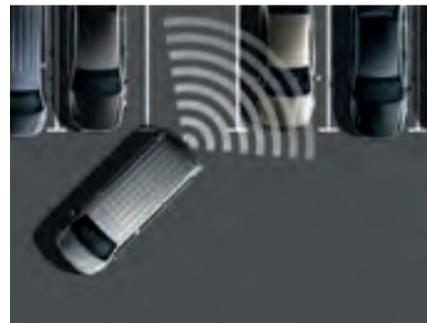
**La caméra de recul " Rear Assist ".** L'image de la caméra s'affichant sur l'écran du système de radionavigation montre la zone à l'arrière du véhicule et la trajectoire prévue lors des manœuvres de stationnement et de recul.
