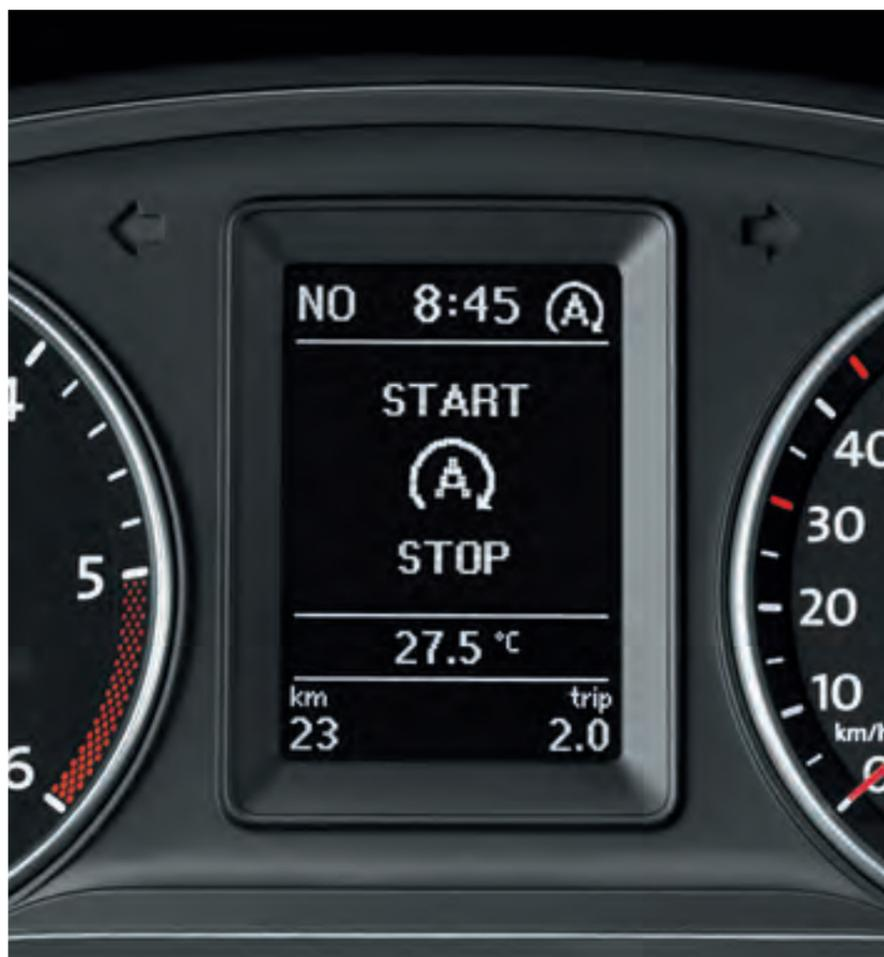
**Le système Start-Stop.** Le système Start-Stop vous aide à conduire de façon économique. Par exemple, au feu rouge : vous êtes au point mort et le moteur s'arrête. Lorsque le feu passe au vert, vous réembrayez et le moteur redémarre.
