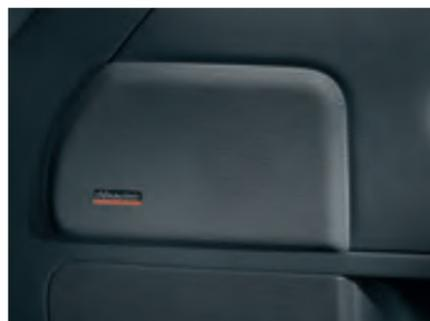
**Le système acoustique DYNAUDIO.** Associé à un amplificateur dix voies, dix notes aiguës, moyennes et graves soigneusement harmonisées vous garantissent une superbe sonorité. Peut être combiné avec les radios "RCD 310", "RNS 315" et "RNS 510".
