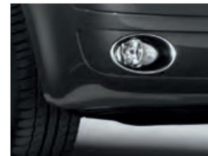
**Les feux antibrouillard.** En cas de mauvais temps, ils assurent une visibilité optimale et donc une sécurité maximale. Des feux de virage sont intégrés dans les projecteurs antibrouillard.
