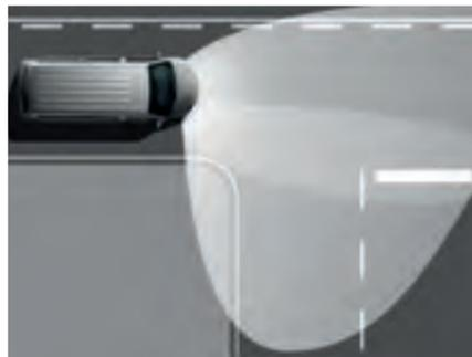
**L'éclairage statique d'intersection.** Combiné aux phares antibrouillard, il permet d'éclairer le côté de la chaussée dès que vous roulez à 40 km/h ou moins. Il vous aide ainsi à détecter les dangers potentiels.
