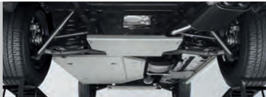
Le Pack "Protection". Il se compose de quatre éléments en aluminium qui protégeront le moteur et la boîte de vitesses, le bas de caisse, le différentiel arrière, le silencieux principal, les longerons et le réservoir de carburant. Le Pack "Protection" est disponible pour tous les modèles Multivan dotés de la transmission intégrale 4MOTION.
