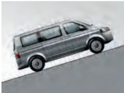
**L'assistant au démarrage en côte.** Ce système évite au véhicule de reculer ou de caler lors d'un démarrage en côte, le conducteur peut ainsi manœuvrer le véhicule plus facilement et plus confortablement.
