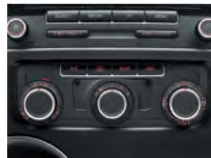
**La climatisation " Climatic ".** Elle dispose d'un capteur de l'espace intérieur et équilibre la température de l'habitacle au degré souhaité. La température et les ventilateurs peuvent être réglés individuellement, même pendant le voyage.
