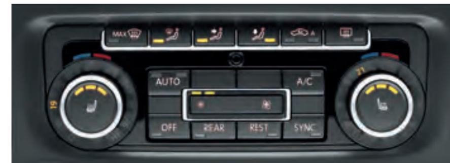
**La climatisation " Climatronic ".** Ce système offre une régulation individuelle de la température dans trois zones : pour le conducteur, le passager avant et les occupants arrière. Il identifie l'intensité du rayonnement solaire et la température extérieure afin d'apporter plus ou moins d'air frais. La commutation automatique et le capteur de qualité de l'air créent une température agréable.
