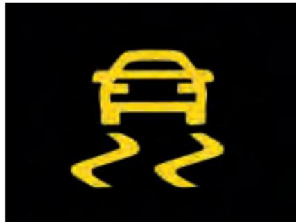
**Le correcteur électronique de trajectoire.** Avec le blocage électronique de différentiel (EDS), il permet de corriger la trajectoire en agissant sur le système de freinage, lors de situations critiques.<sup>1)</sup>
