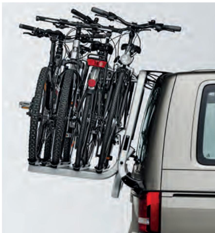
**Le porte-vélos.** En profilé d'aluminium anodisé, avec dispositif de verrouillage, il permet de transporter jusqu'à quatre vélos. Pré-monté et donc particulièrement simple à installer sur le hayon arrière. Muni d'un dispositif de fermeture antivol. L'ouverture du hayon n'est pas gênée par le montage du porte-vélos (sans les vélos). Poids net : 13 kg. Charge admissible : 60 kg.
