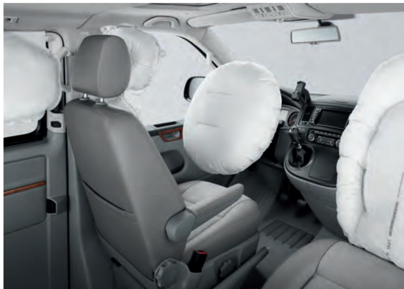
**Les airbags.** Toute personne amenée à prendre le volant quotidiennement doit bénéficier d'une protection optimale. Le Multivan est donc équipé de série d'airbags volant et tableau de bord, ainsi que d'airbags latéraux et rideaux placés sur les montants de porte, tous de série pour le conducteur et le passager avant. Des airbags rideaux, en option, protègent les occupants dans l'espace passagers.\* L'airbag passager peut être désactivé à l'aide de la clé du véhicule.
