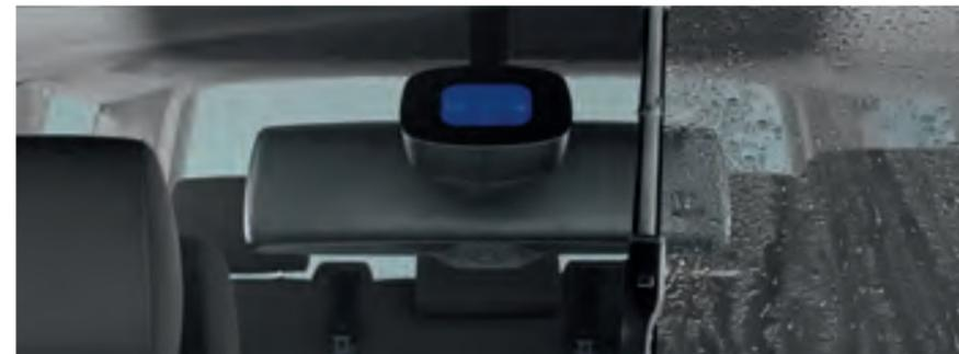
**Le rétroviseur intérieur jour-nuit automatique et détecteur de pluie.** Le rétroviseur intérieur évite d'être ébloui par les véhicules qui vous suivent et vous procure une meilleure visibilité vers l'avant. Le rétroviseur est en outre doté d'un détecteur de pluie qui enregistre la moindre goutte sur le pare-brise et active immédiatement les essuie-glaces.
