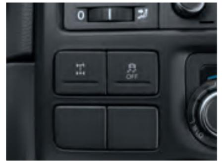
**Le blocage du différentiel.** En combinaison avec la transmission 4MOTION, un blocage du différentiel est disponible pour l'essieu arrière.
