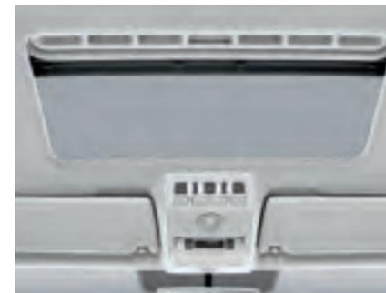
**Le toit ouvrant coulissant / entrebaillable.** Il est commandé par un système de préselection automatique ou par le commutateur du ciel de toit. En cas de résistance, une protection électronique arrête immédiatement le processus.
