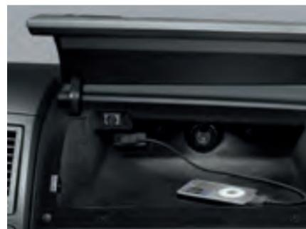
**Les interfaces AUX-IN et MEDIA-IN.** Les câbles adaptateurs permettent de raccorder des sources audio externes (lecteur CD et MP3, iPhone et iPod). La commande s'effectue par l'intermédiaire de la radio ou du système de navigation.
