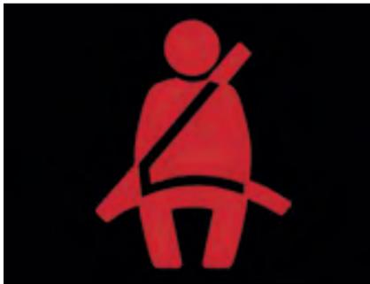
**L'avertisseur de non bouclage de ceinture de sécurité.** Il signale au chauffeur que celle-ci n'est pas bouclée. Cet avertissement est à la fois optique et acoustique.
