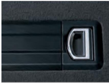
**Les œillets d'arrimage.** Pour sécuriser le chargement, six œillets d'arrimage sont prévus dans le compartiment passagers et le coffre. Le Multivan Startline possède deux autres œillets au niveau du montant C.
