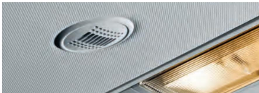
**L'amplificateur digital de la voix (DVE) de deuxième génération.** Des microphones disposés au-dessus du conducteur et dans le ciel de toit du compartiment passagers rendent les discussions encore plus agréables. Le DVE n'est disponible qu'avec les systèmes de radionavigation "RCD 310" et "RNS 510". Une préparation téléphone est nécessaire avec le DVE, de sorte que les occupants peuvent aussi converser avec la personne qui appelle.
