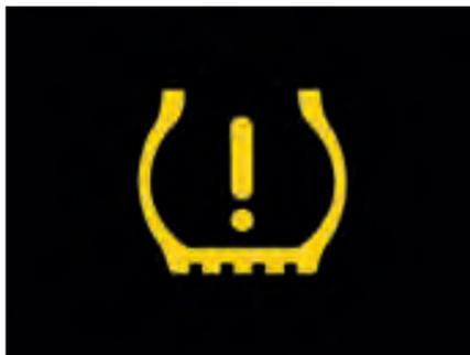
**L'indicateur de perte de pression des pneus "Plus".** Il indique, dans les limites du système, la différence de pression sur un pneu. Le symbole d'avertissement invite à vérifier la pression du pneu dans les plus brefs délais.
