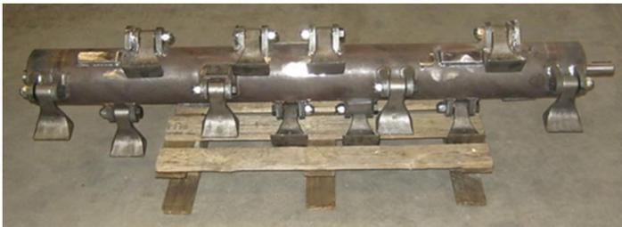
*Rotor de broyeur VNBR 140*
