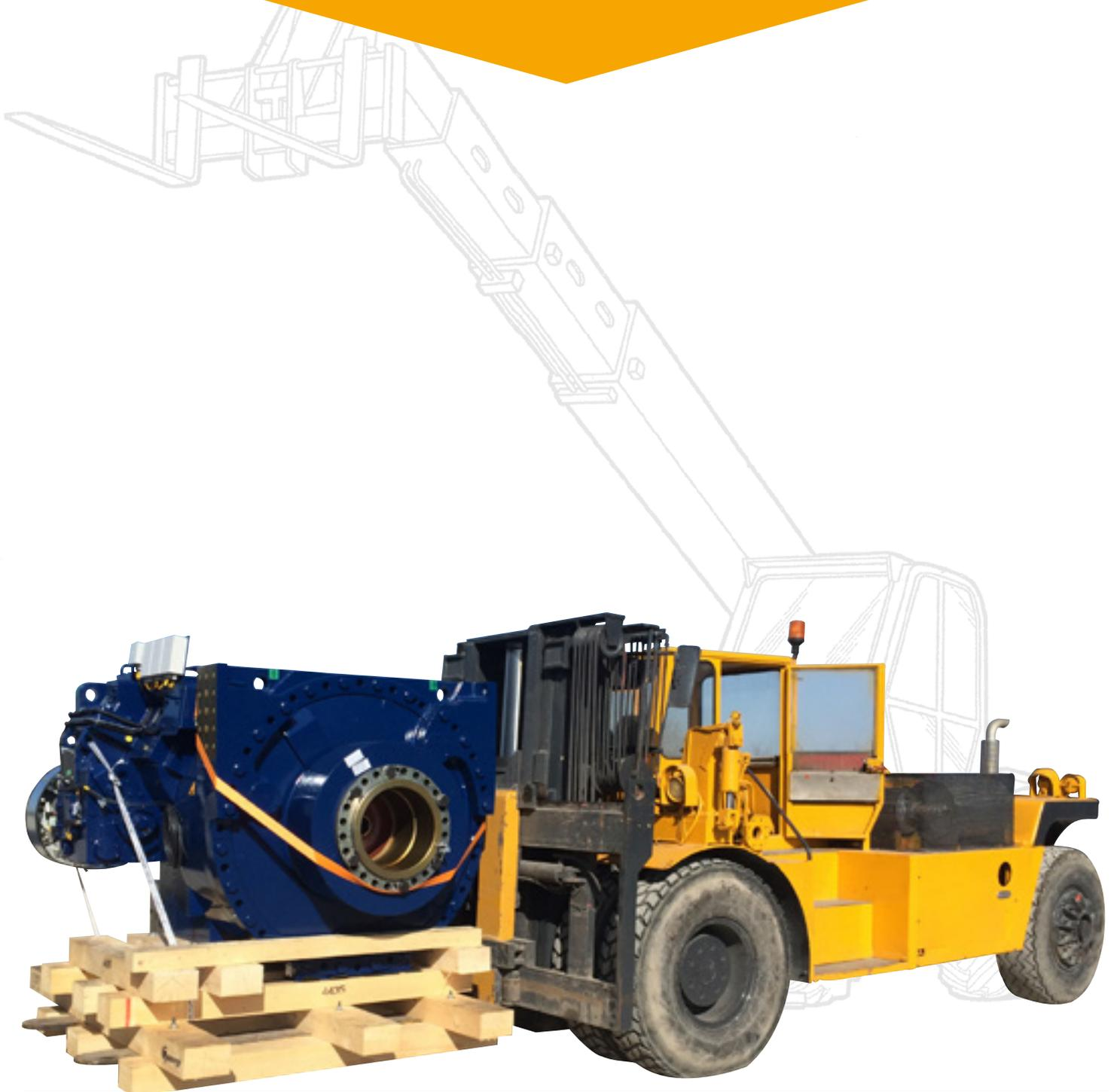
Souvent complémentaire au levage et au transport, la manutention nous permet la mise en place de machines sous bâtiment à l'aide de chariots rouleurs, crics manuels, vérins hydrauliques ou avec des élévateurs si la place nécessaire est suffisante.
